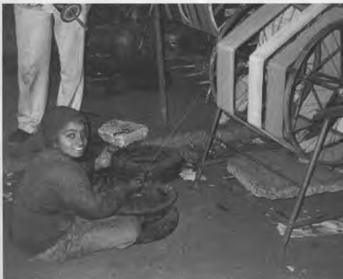
Hier wird die Schnur durch ein Bad aus den Grundstoffen Glas, Leim und Farbe gezogen und zum Trocknen aufgetrommelt.
